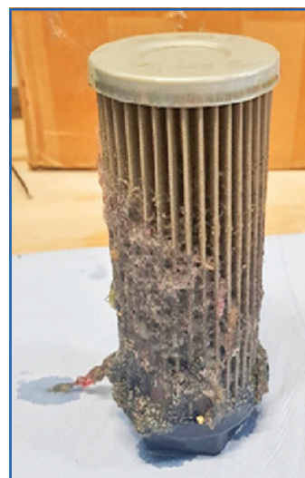
Vplyv mäkkých kalov na prvky hydraulického systému (Fotky z praxe Filter Technik Slovakia s.r.o.)
